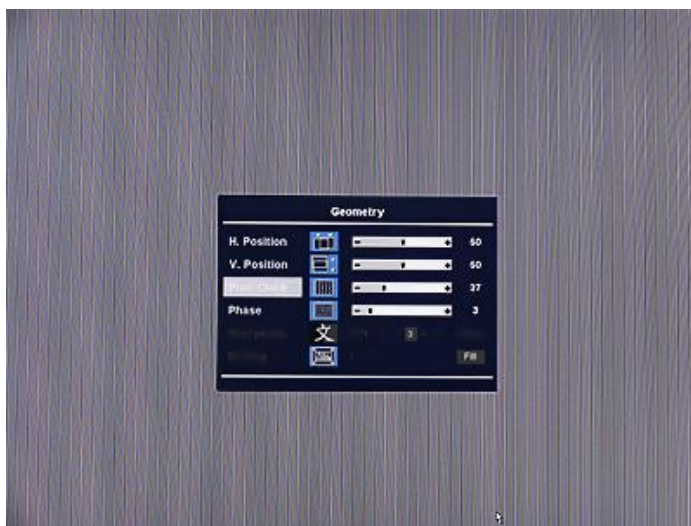
Настройка частоты в OSD-меню. На снимке хорошо видны вертикальные полосы на экране, возникающие из-за неточной установки частоты
