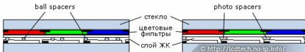
Рис.8. Шариковые распорки и распорки колонного типа
