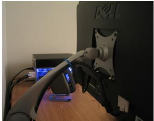
Площадка под крепление стандарта VESA 100 mm (слева) и кронштейн для настольного крепления монитора VESA 75/100mm с поворотным шарниром (справа)
