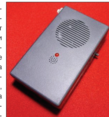
Рис.3 Имитатор разбивания стекла "Астра-961"
