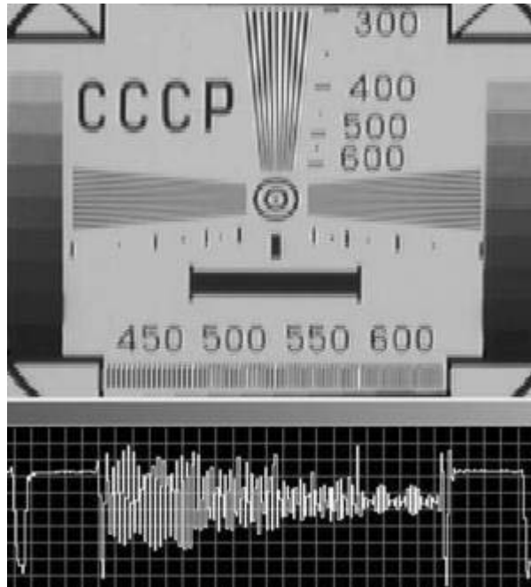
Рис.14 Иллюстрация изображения муаров вертикального клина тест-таблицы, наблюдаемой телевизионной камерой на матрице ПЗС. Внизу – осциллограмма строки в центре горизонтальной миры 450 – 600 телевизионных линий. Муары выражаются в низкочастотной модуляции осциллограммы.
