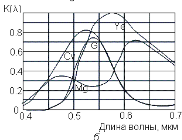
Рис. 2. Цветоделительные фильтры цветной матрицы ПЗС: а – пространственное расположение, б – относительные спектральные характеристики
